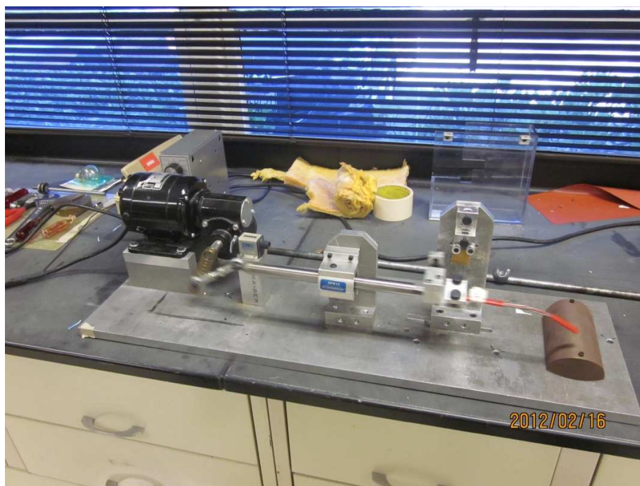
图 11 磨损装置实样图
