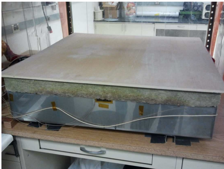
图 6 带上保温层的测试板
